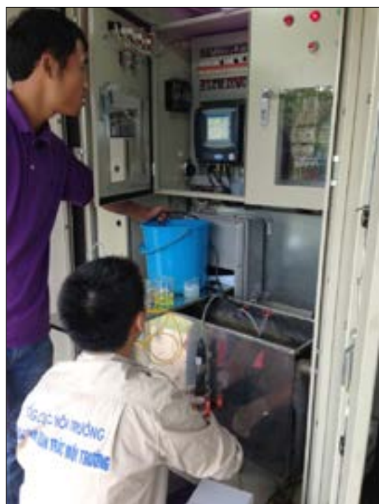
▲ Hiệu chuẩn bên trong Trạm quan trắc nước tự động
